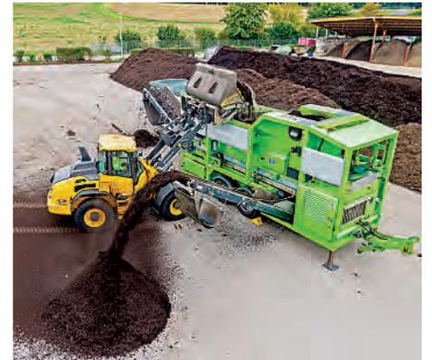
Im Siebprozess wird Kompost, Gärgut und Humus mittels Magnetabscheider und Windsichter von Eisen und Plastik befreit.
