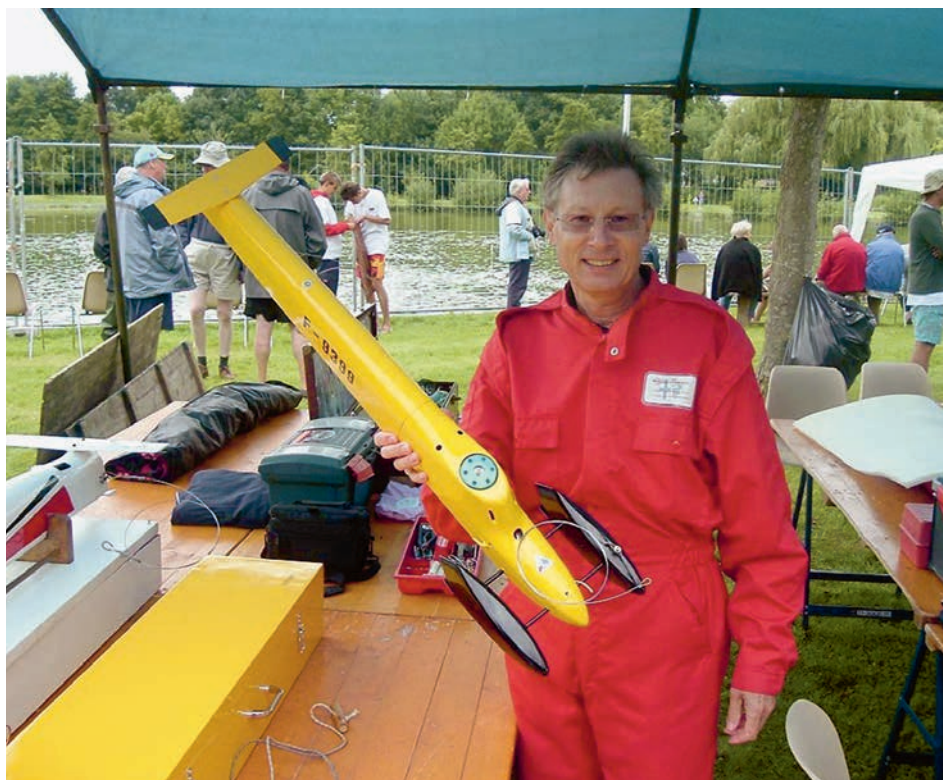
Der Weltmeister Gilbert Huguenin mit seinem Rennboot. Man sieht nebst dem gelben Rumpf die schwarzen Schwimmer, am Heck den Flügel (Spoiler) und den grünen Zylinder des 10 ccm-Motors.
