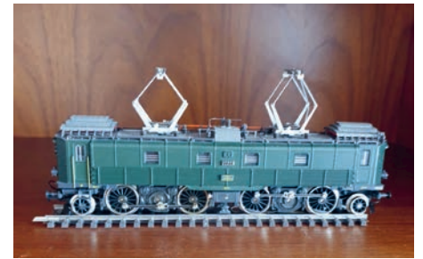
Eines der Modelle, die Bernard besitzt: eine SBB-Lok BE 4/6, auch «Warmluft-Lok» genannt wegen der Kühlaggregate auf dem Dach. Bernards Herzstück.
