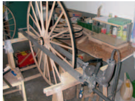
Das Rad ist in einen Rahmen gespannt, die fixierte Bohrmaschine garantiert exakt gebohrte Löcher.
