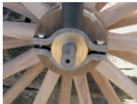
Die Nabe aus Eiche, die Speichen und die Felge aus Eschenholz, wie das Original.
