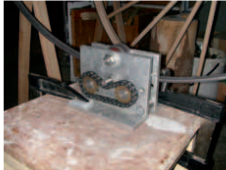
Biegeapparat: Zwei fixe und eine bewegliche Rolle gespannt mit einer Kette, auf der Rückseite eine Kurbel, damit wird die genaue Biegung der Felgen-Stahlreifen erreicht.
