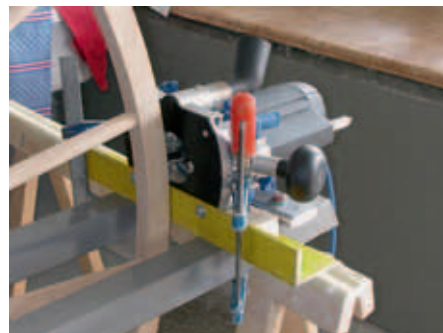
Eine festgemachte Oberfräse korrigiert den Rundlauf des Rades.
