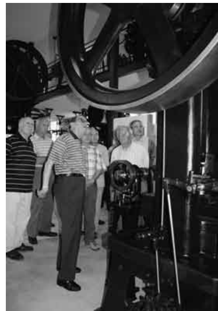
Die grösste ausgestellte Maschine ist eine Exzenterpresse. Sie erzeugt einen Druck von 320 Tonnen und wiegt selber 14,5 Tonnen.
